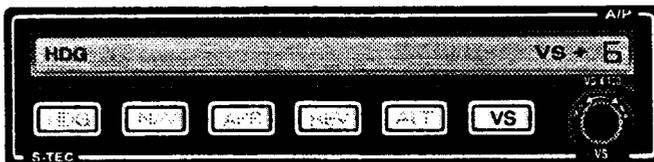
Le PA affiche et maintient la vitesse verticale de l'avion au moment de la sélection du mode VS; dès lors, le pilote peut modifier la vitesse verticale à l'aide du curseur rotatif.
