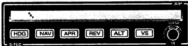
Si l'autotest trouve une anomalie, le message FAIL apparaît et le pilote automatique ne peut être engagé.
